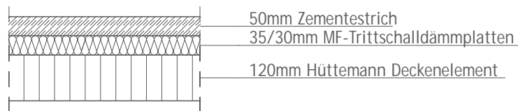
Deckenaufbau 1: Bewerteter Norm-Trittschallpegel L'_{n,w} = 66\text{dB}
