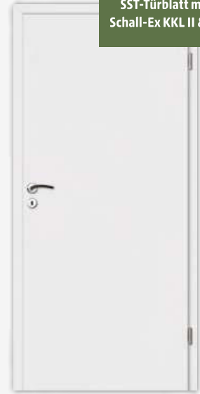
Schallschutz-Türblatt (SST) Schallschutz (SD32 = Rw, P 32 dB) Klimaklasse II oder III, inkl. Schall-Ex Bänder V0026, PZ vorbereitet.
