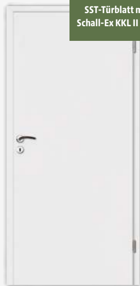
Schallschutz-Türblatt (SST), Rundkante (RP) mit Schallschutz, (SD-32 = Rw, P 32 dB) Klimaklasse II oder III inkl. Schall-Ex Bänder V0026, PZ vorgerichtet.
