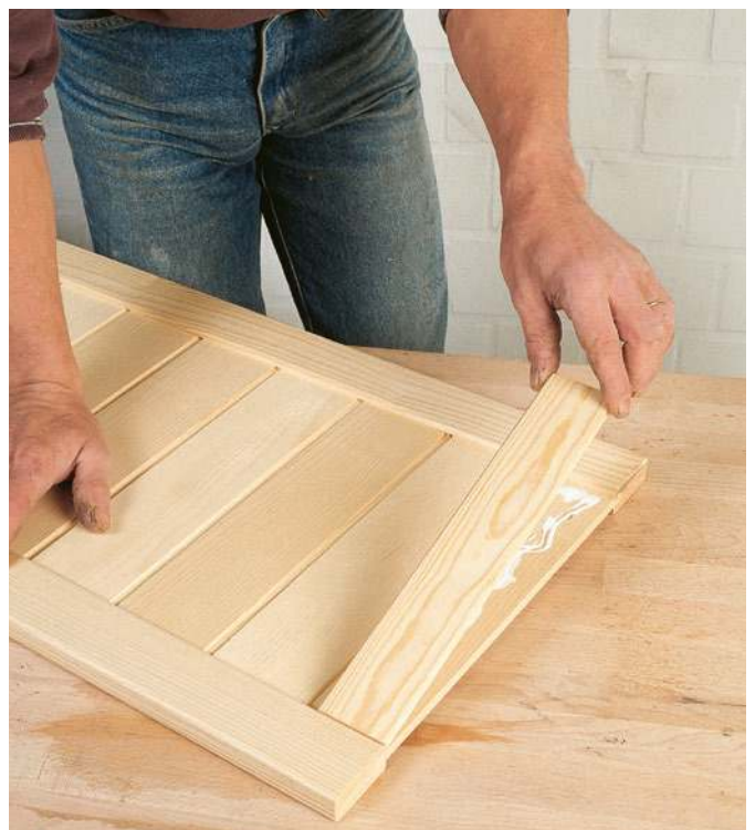
Möbelzuschneidetüren: Anleimen der Rahmenabschlussleiste
