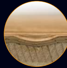
Herkömmliches Parkett mit Fichte-Mittellage (Deckschicht Eiche 3,6 mm)
